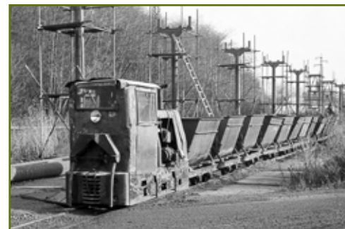
Lokomotiva BN30R tlačí 30. listopadu 1979 vysypanou soupravu 12 vozíků zpět do chemičky. Vedle drážky jsou již postaveny sloupy potrubí pro plavení popílku.
